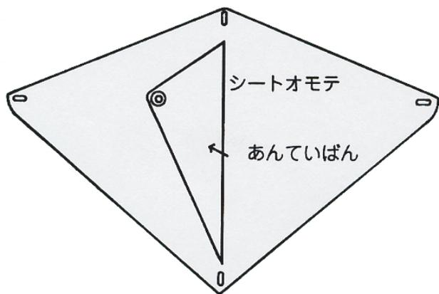
② シートをウラがえしてウラがわにします。まるぼうをジョイントにさしこみます。ジョイントのむきにちゅういしてください。
