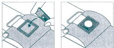
●先にデジタル時計の動作確認をしてから、ボタン電池が手前になるようにセットします。
